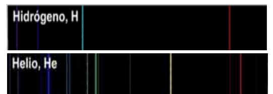
Espectros de emisión de H (arriba) y del He (abajo). No son continuos. Constan de rayas de diversos colores separadas por amplias zonas negras en las que no se observa luz.
